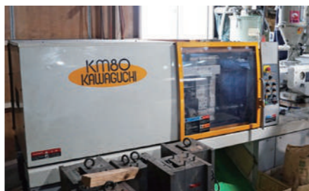
射出成形 溶かした樹脂を金型に流し込んで、ルアーの元となるボディを成形します。
