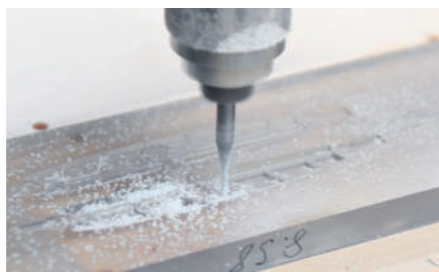
プロトモデル製作 ルアーの形状やアクション確認用の試作品を製作します。
