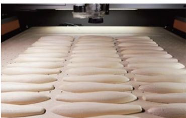
ウッドブランク ウッドブランクの設計からNC加工機による量産を行っております。
