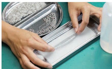
組立 ルアーの溶剤接着、バリ取り、研磨、浸水検査を行います。
