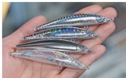
箔転写 ルアーにホログラムを熱転写します。
