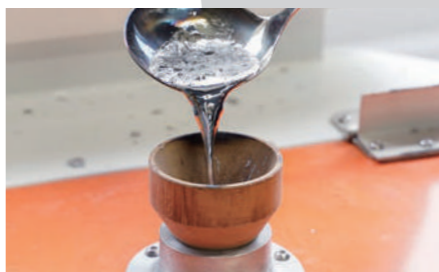
鋳造 溶けた鉛を流し込み、鉛製ルアーやルアー内部ウェイトを製作します。
